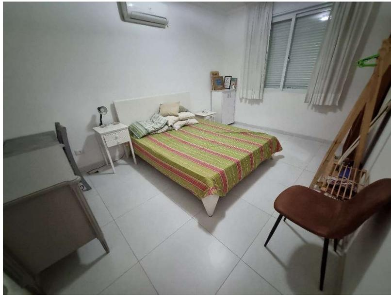
**Foto 22** - Vista do dormitório II da unidade privativa 33, unidade similar ao apartamento avaliando, apresentando as seguintes características construtivas: piso em revestimento cerâmico, paredes e teto em pintura látex sobre massa corrida com molduras de gesso; esquadrias da porta em madeira e da janela em alumínio.
