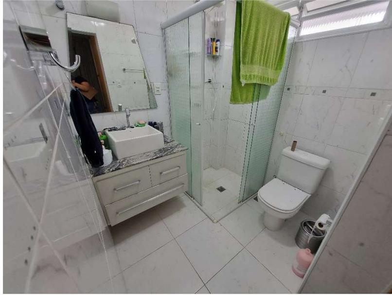
**Foto 24** - Vista do banheiro da suíte da unidade privativa 33, unidade similar ao apartamento avaliando, apresentando as seguintes características construtivas: piso e paredes em revestimento cerâmico e teto em pintura látex sobre massa corrida com molduras de gesso; esquadrias da porta em madeira e da janela em alumínio.
