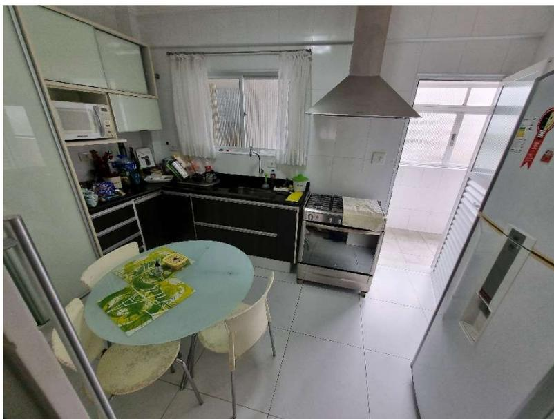
**Foto 18** - Vista da cozinha da unidade privativa 33, unidade similar ao apartamento avaliando, apresentando as seguintes características construtivas: piso e paredes em revestimento cerâmico e teto em pintura látex sobre massa corrida com molduras de gesso; esquadrias das portas em madeira e alumínio, da janela em alumínio.
