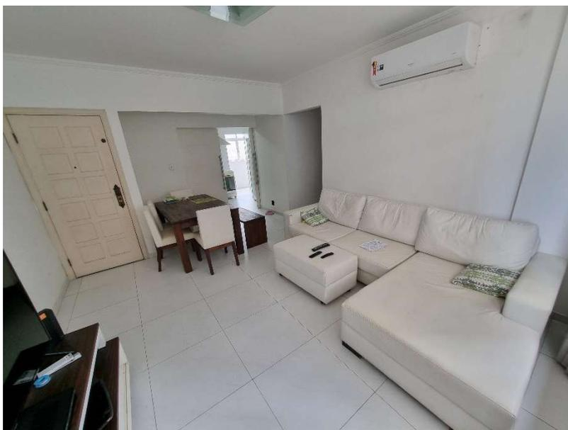
**Foto 19** - Vista da sala para dois ambientes da unidade privativa 33, unidade similar ao apartamento avaliando, apresentando as seguintes características construtivas: piso em revestimento cerâmico, paredes e teto em pintura látex sobre massa corrida com molduras de gesso; esquadrias da porta em madeira e da janela em alumínio.
