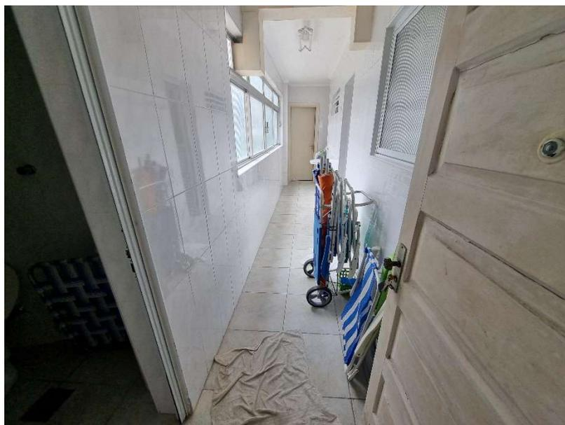
**Foto 15** – Vista da área de serviço da unidade privativa 33, unidade similar ao apartamento avaliando, apresentando as seguintes características construtivas: piso e paredes em revestimento cerâmico e teto em pintura látex sobre massa corrida com molduras de gesso; esquadrias da porta em madeira e janela em alumínio.
